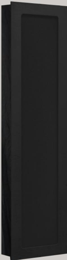
Linienstrahler Flächenlautsprecher nach dem Prinzip des Biegewellenwandlers mit einer Flächenmembran, die durch rückseitig aufgebrachte Exciter zum Schwingen angeregt wird und durch eine spezielle Konstruktion die prinzipbedingte diffuse Abstrahlcharakteristik in eine Direktschall Abstrahlcharakteristik gewandelt wird.
